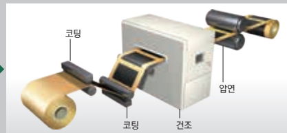
5 코팅·건조·압연 전극재를 금속박에 균일하게 도포합니다. 도포된 전극재에 뜨거운 바람을 가하면 습기가 금속으로 흡인되어 빠르게 건조 됩니다. 전극을 롤러로 압연하여 밀도를 높입니다.
