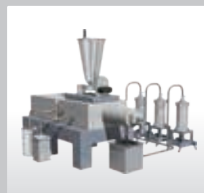
4 계량·혼련 양극재·음극재의 적정량을 계량한 재료를 혼합하여 페이스트 상태로 만듭니다.
